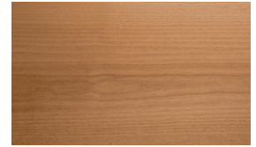
Lämpöhaapa laudepuu Leveys 90 mm. Asennetaan takaseinän suuntaisesti.
